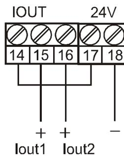
Свързване на електрод APS-X5K, ARS-X5K
