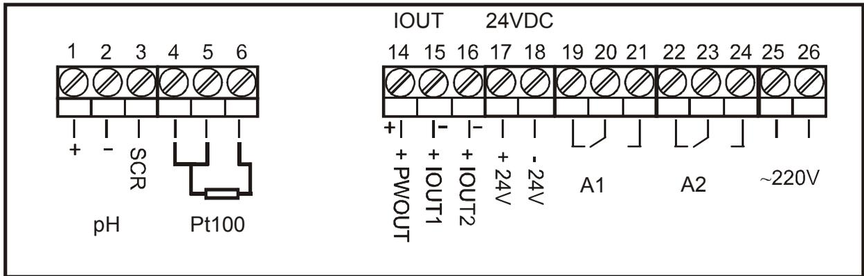
Свързване на токовия изход с външно захранване
